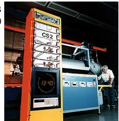
Cs-Atomuhr bei der PTB ( www.ptb.de )
